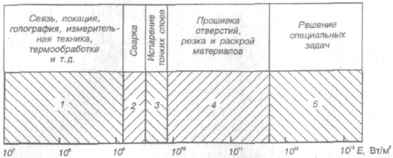
Рис. 56 Области применения лазеров в зависимости от требуемой мощности лазерного излучения
