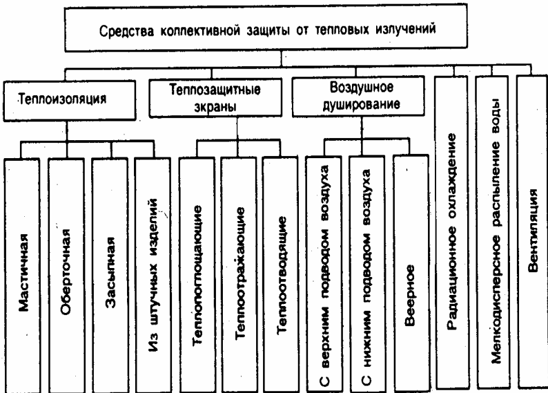
Рис. 59 Классификация средств промышленной теплозащиты
